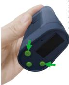
Nachdem Sie das Oberteil ausgetauscht haben, drücken Sie den Netzschalter 5 Mal hintereinander, um das Gerät einzuschalten. Wählen Sie die gewünschte Temperatur mit den Aufwärts- und Abwärtstasten auf der Interseite des Gerätes.
